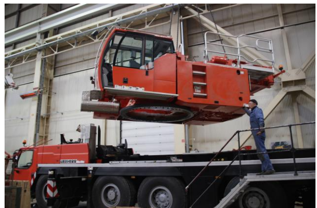
Drehkranzverschraubung bei Mobilkran.jpg In nahezu jeder Branche werden lackierte Bauteile miteinander verschraubt – wie auch hier bei einem Mobilkran, wo der Oberwagen über den Drehkranz mit dem Unterwagen verbunden wird.
