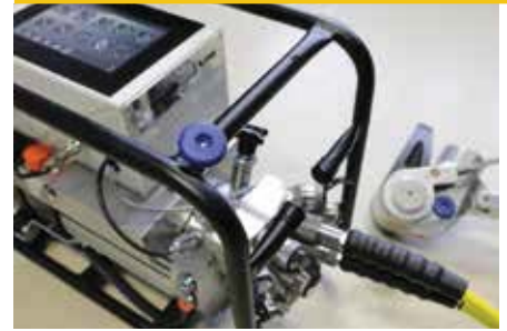
»3 Hydraulisches Schraubmontagesystem Smartorc-Eco2Touch (Bild: Barbarino & Kilp GmbH)
