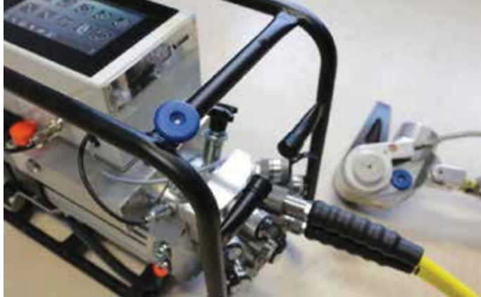
»1 Beispiel für VDI/VDE 2862 Blatt 2 konformes Schraubsystem mit der Eco2Touch Smarttorc®
