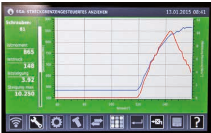
Streckgrenzengesteuertes Anzugsverfahren einer Drehkranzverschraubung: links die Darstellung des Anzugsprozesses. Der Bediener der dafür eingesetzten intelligenten Dokumentations-Hydraulikpumpe wird durch die intuitive Menüführung der angeschlossenen elektronischen Steuereinheit unterstützt.
