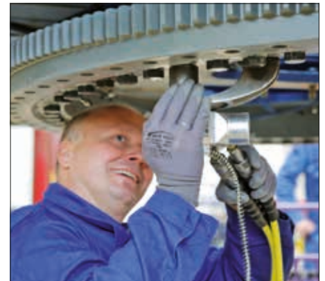
Holger Junkers bei einer Drehkranzverschraubung im streckgrenzengesteuerten Anzugsverfahren bei Liebherr, Oberhausen
