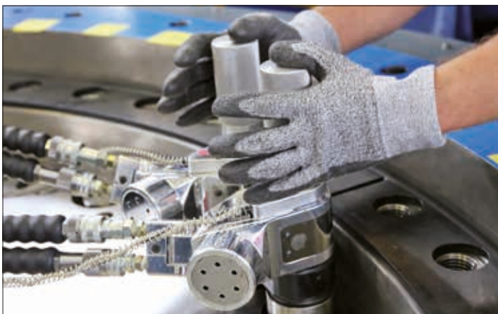
Absolute Prozesssicherheit gefordert: Simultanverschraubung mit vier Werkzeugen (zwei davon im Bild) an einem Castorbehälter. Die jeweils gegenüberliegenden zwei Schraubenpaare werden drehmomentgesteuert und drehwinkelüberwacht bei zeitgleicher Protokollierung verschraubt.
